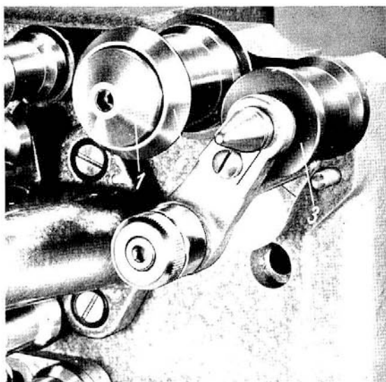
Abb. 9 Beruhigungsrollenhalter 1 Abschluß-Scheibe 2 Friktionsrolle 3 Gummirolle
