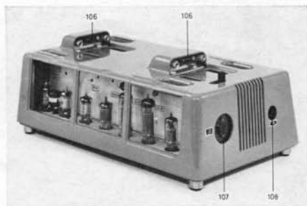
Bild 26 BAUER-15-W-Verstärker PV5M1/3 (Schutzklappen abgenommen)
