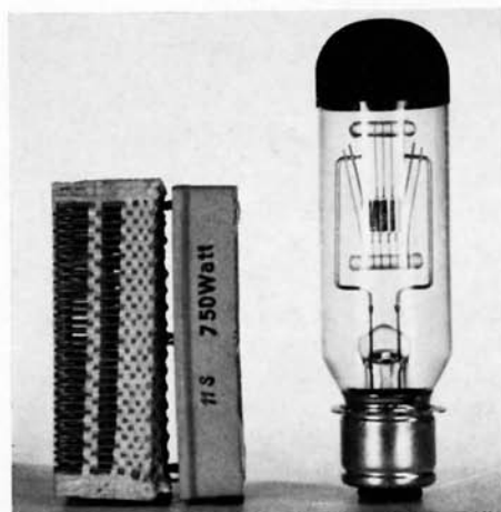
Bild 8 Projektionslampe 750 W / 100 V mit Einsteckwiderstand
