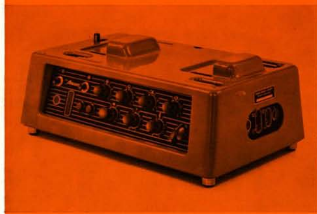
15-Watt-Universal-Röhrenverstärker für Lichtton- und Magnetton-Wiedergabe sowie Magnetton-Aufnahme.
