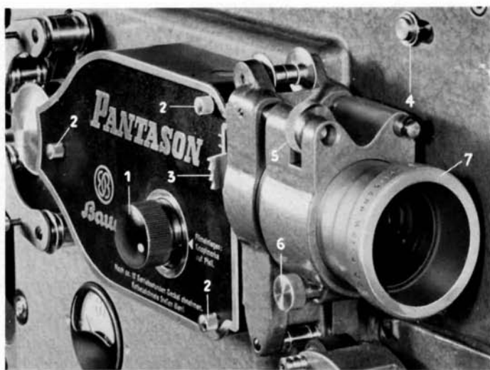
Abb. 6: Greiferkasten mit Objektivhalter.
