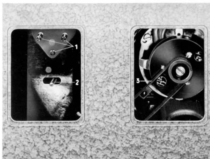
Abb. 11: Rückseite des Projektors mit geöffneten Abdeckblechen.
