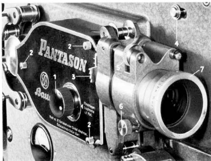
Abb. 10: Greiferkasten mit Objektivhalter.
