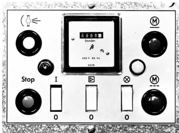
Bild 3 Projektor-Schalttafel mit Betriebsstundenzähler
