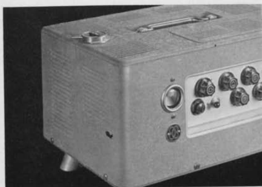
Abb. 19 Sperrriegel am Ge- häuse des Verstärkers; der hintere Fuß des Projektors wird in die Schlitzöffnung ein- gestellt. Durch Links- drehen des heraus- ragenden Hebels wird der Projektor gegen Umfallen gesichert
