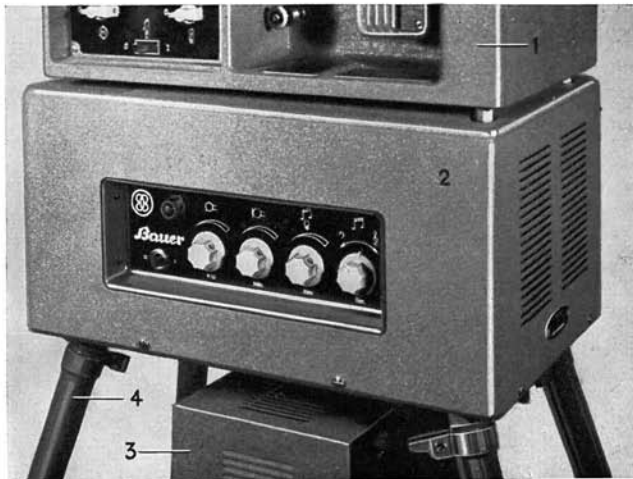
Abb. 5 Der Klangfilmverstärker dient gleichzeitig als Tisch für den Projektor und besitzt eine Einhäng-einrichtung für den Transformator. 1 = Projektor; 2 = Verstärker; 3 = Transformator; 4 = Stativ.
