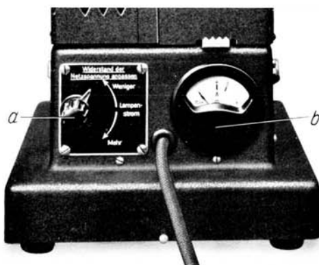
Bild 7. Sockel mit Strommesser und Widerstands-drehknopf.
