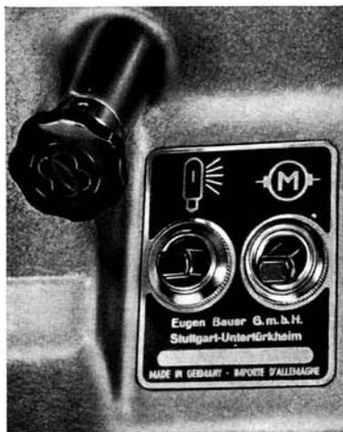
Abb. 11 Schalterplatte des Projektors
