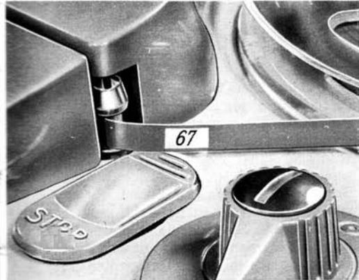
Abb. 40 Markierung des Bandes an der durch Klopffzeichen festgelegten Stelle mit numerierter Klebmarke
