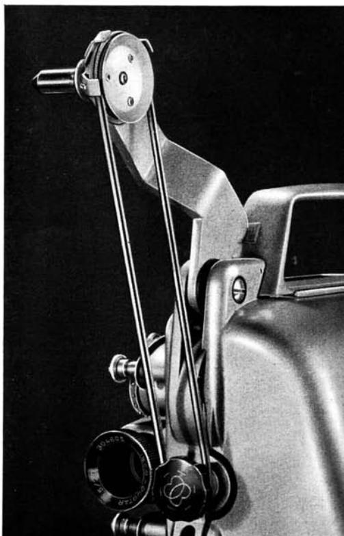
Abb. 19 Rückwickelpese in richtiger Stellung für das motorische Rückspulen
