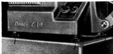
Abb. 12 Höhenverstellung des T10 (Pos. 2 und 3) und zum Ausgleich einer Schrägstellung (Pos. 1)
