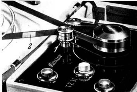
Abb. 39 Der Silberstreifen (Pos. 2), auf der Außenseite des Bandes, schaltet beim Vorbeilaufen an der Schallrolle (Pos. 1) den Projektor ein
