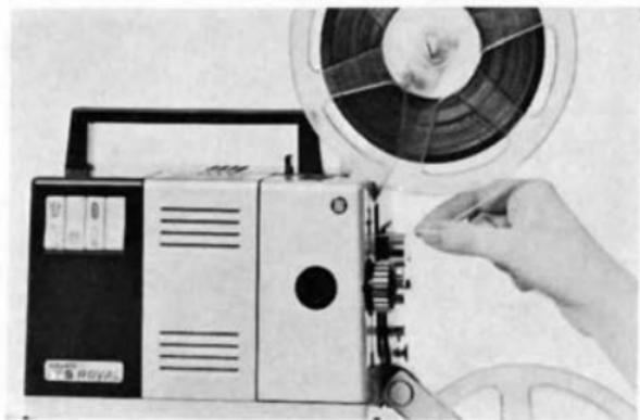
Lampe einschalten ④ und nach Ablauf des Vorspanns Bildschärfe mit dem Rändelrad einstellen.
