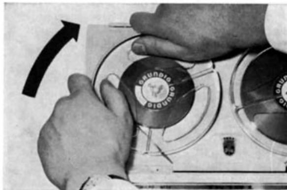
ab); Tonband durch gleichmäßige ruckfreie Drehung der linken Tonbandspule von Hand zurückwickeln.
