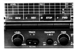
Zur gewollten raschen Entriegelung der Aufnahmetasten sollte die »TRANSFER«-Taste 24 betätigt werden. Die »TRANSFER«-Taste ihrerseits springt beim leichten Antippen einer »TRACK«-Taste oder beim Betätigen einer Laufwerk-Taste (»REW«, »REV« oder »FWD«) wieder heraus.
