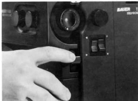
Nachdem Ihr Film ganz durch den Projektor gelaufen ist, führen Sie ihn über die Abwicklung 5 zur Abwickelpule und befestigen ihn. Jetzt drehen Sie Betriebsschalter 4 auf Stufe 1 nach links (Rücklauf ohne Licht), der Film wird schnell zurückgespult.
