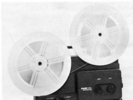
Zum Wiederholen einer Filmszene bzw. zur Rückwärtsprojektion drehen Sie Betriebsschalter 4 über die »0«-Stellung auf Stufe 1 (Rückwärtslauf ohne Licht) oder Stufe 2 (Rückwärtsprojektion) nach links.
