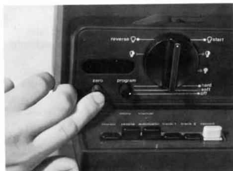
Dann drücken Sie die Zero »0«-Taste 2 des elektronischen Zählwerks. Der Startpunkt des automatischen Toneinsatzes ist dann bildgenau programmiert.
