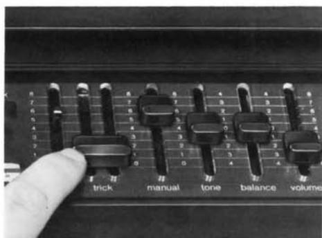
Schieben Sie jetzt den Trickregler 28 langsam von »0« in Richtung »8«. Entweder notieren Sie die Trickreglerstellungen beim Einblenden vom Tonbandgerät anhand der Filmszenen, oder aber Sie sprechen über das Mikrofon die jeweilige Position des Trickreglers auf. Am Mikrofon muß dabei die Einblendtaste eingedrückt sein.
