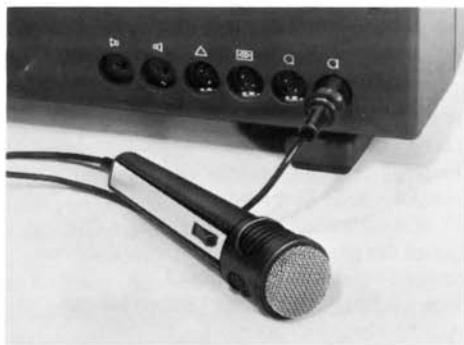
Schließen Sie das Mikrofon an Buchse **42** an. Wählen Sie die entsprechende Aufnahmebetriebsart (s. Tabelle). Je nach Stellung des Wahlschalters **1** erfolgt nach Starten des Projektors die Toneinblendung »hart« oder »weich«.
