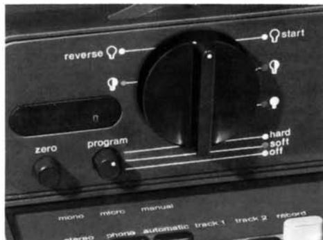
Wird Wahlschalter **1** auf »soft (weich)« gestellt, erfolgt eine automatische Toneinblendung an der vorgewählten Einsatzstelle in ca. 1,5 sec. Steht der Schalter **1** auf »hard (hart)«, setzt die Tonaufnahme bildgenau an der gewünschten Startstelle ein.
