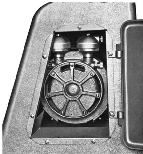
Kühlgebläse, im Fuß der Projektorsäule eingebaut
